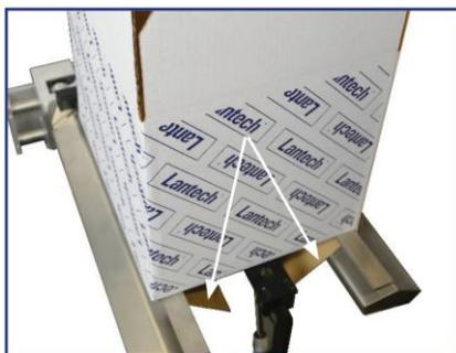
**Фиксированное закрытие клапанов**
