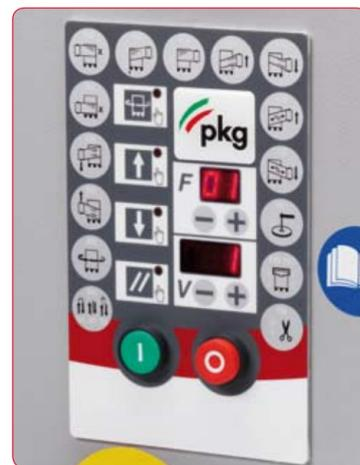
**It\_** Quadro comandi a microprocessore con pannello digitale per la scelta del ciclo di avvolgimento e per la regolazione dei parametri (con possibilità di personalizzare il ciclo di avvolgimento).
